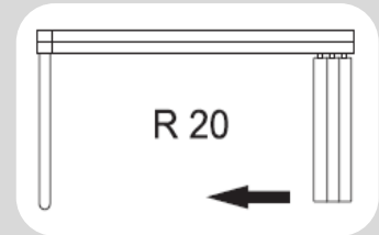
Typ R 20 •Paket rechts •Bedienung links
