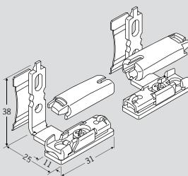
**Winkel für Klebeprofil mit Spannschuh, Paar**
